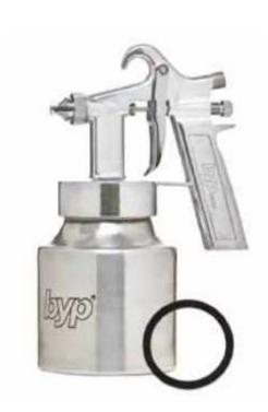
PISTOLA DE SUCCIÓN QUE MEZCLA LA PINTURA CON EL AIRE DE MANERA EXTERNA, TRABAJA CON BAJA PRESIÓN E INCLUYE VASO DE METAL. ES FÁCIL DE OPERAR Y MANIOBRAR, SU BAJO CONSUMO DE AIRE, LA HACE ESPECIAL PARA TRABAJOS CON MATERIALES DE BAJA VISCOSIDAD.
